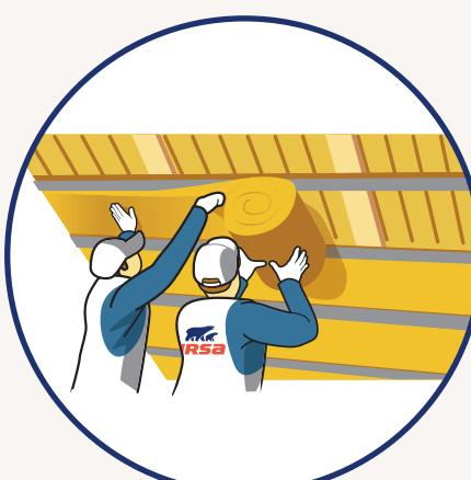
Aplikace minerální izolace URSA DF 38 do příčného kovového roštu upevněného na krovky, jako druhá tepelně izolační vrstva. Izolaci vkládáme lehkým vtláčením po celé délce roštu. Dbejte stejných zásad jako v předešlém aplikačním kroku.
