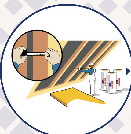
Změříme si šířku rozteče krovků. Pro zajištění lepší fixace minerální izolace URSA DF 38 mezi krovkami přidáme k naměřenému rozměru ještě 2 cm.
